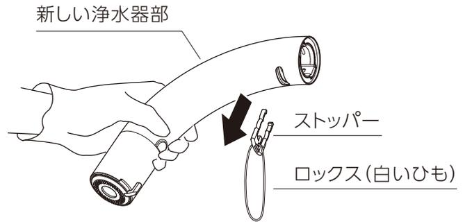
②フレキシブルホース先端を新しい浄水器部に差し込む。
