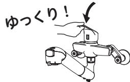
この水栓は、構造上左右に可動します。シンクより吐水部がはみ出す場合がありますので、ご使用の際は吐水部の位置を確認してから水を出してください。 吐水部
