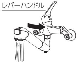
湯を使うときは、必ず水側から吐水し、ゆっくり湯側に回して温度を調節してください。
