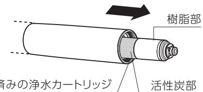
ヘッドをはずす際に、浄水カートリッジが一緒に出てきた場合は、浄水カートリッジの樹脂部を持ってまっすぐ引き抜いてください。活性炭部を持って引き抜くと樹脂部と分離して浄水カートリッジが破損し、浄水カートリッジの取り替えができないことがありますので注意してください。
