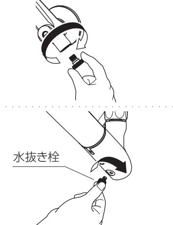
⑥再使用時に配管部の止水栓などにより通水を再開し、水漏れがないことを確認してください。
