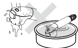
切替表示部は完全に密閉されていない為、水が浸入します。浄水器部に直接水をかけたり、水没させたりしないでください。
