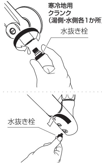
⑤水が完全に出なくなったら、図のように水抜き栓を取り付けます。その後、レバーハンドルを止水状態にし、浄水器部を元に戻してください。
