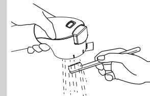
①水形切替スクリーンを「ストレート」に合わせ、吐水口にある凹部に定規もしくはティースpoonの柄などをあて、図のように回してはすします。
