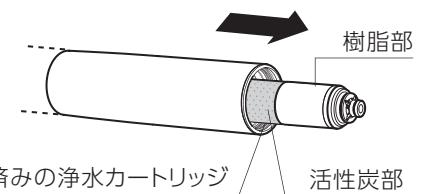
ヘッドをはずす際に、浄水カートリッジが一緒にについて出てきた場合は、浄水カートリッジの樹脂部を持ってまっすぐ引き抜いてください。活性炭部を持って引き抜くと樹脂部と分離して浄水カートリッジが破損し、浄水カートリッジの取り替えができないことがありますので注意してください。
