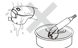
切替表示部は完全に密閉されていない為、水が浸入します。
