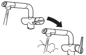
浄水器部を掃除する際は、レバーハンドルで止水し、グリップとフレキシブルホースが熱くないことを確認してください。
