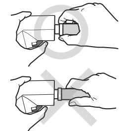
③新しい浄水カートリッジをグリップに入れ、ヘッドをグリップにハメ込み、矢印の方向へ回転させます。
