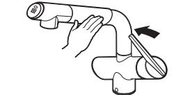
正常な温度調節を行うために、給湯圧力を給水圧力より低くするか、同圧にしてください。給湯圧力を加圧する場合も同様です。
