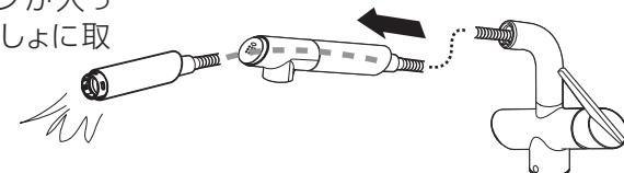
ヘッドの取りはずし方はp.16「浄水カートリッジの交換方法」を参照してください。
