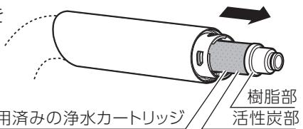
ヘッドをはずす際に、浄水カートリッジが一緒に出てきた場合は、浄水カートリッジの樹脂部を持ってまっすぐ引き抜いてください。活性炭部を持って引き抜くと樹脂部と分離して浄水カートリッジが破損し、浄水カートリッジの取り替えができないおそれがありますので注意してください。
