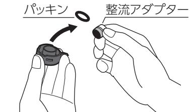
③泡沫アダプターに付け替え、②ではずしたパッキンをかぶせるように取り付けてください。
