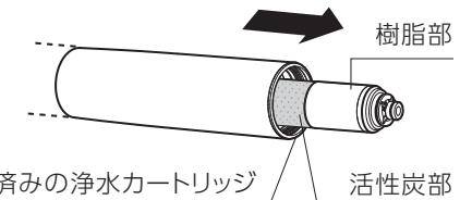
ヘッドをはずす際に、浄水カートリッジが一緒に出てきた場合は、浄水カートリッジの樹脂部を持ってまっすぐ引き抜いてください。活性炭部を持って引き抜くと樹脂部と分離して浄水カートリッジが破損し、浄水カートリッジの取り替えができないなくなるおそれがありますので注意してください。
