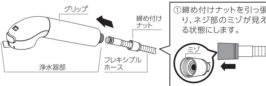
②浄水器部のグリップを持って締め付けナットにまっすぐ入れます。
