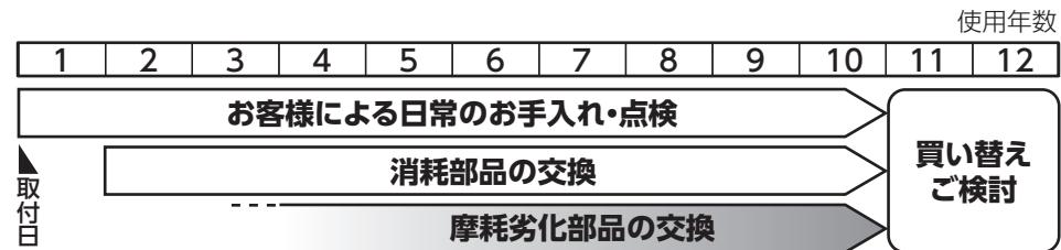
消耗部品(機能を保つ上で消費され、やがては交換されるもの)と摩耗劣化部品(摩擦などにより摩耗し、適正な動作をしなくなるもの)を総称して消耗品と表記しています。
