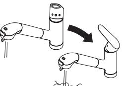
浄水器部を掃除する際は、レバーハンドルで止水し、グリップとフレキシブルホースが熱くないことを確認してください。
