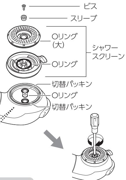
※切替パッキン、Oリングがはずれている場合は、向きに注意して図の位置に取り付けてください。
