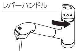
湯を使うときは、必ず水側から吐水し、ゆっくり湯側に回して温度を調節してください。
