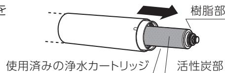
ヘッドをはずす際に、浄水カートリッジが一緒に出てきた場合は、浄水カートリッジの樹脂部を持ってまっすぐ引き抜いてください。活性炭部を持って引き抜くと樹脂部と分離して浄水カートリッジが破損し、浄水カートリッジの取り替えができないことがありますので注意してください。
