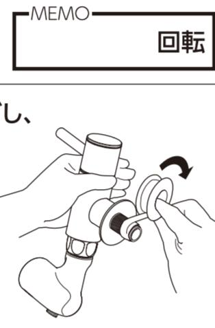
2-2の回転数確認は、壁出し水栓のクランク仮固定時および、単水栓を取り付ける際に、参考となる数値です。
