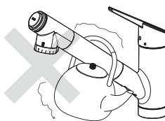
浄水器部を取りはずし、食器洗い乾燥機などで洗わないでください。
