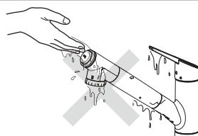
浄水器部は完全に密閉されていない為、水が浸入します。
