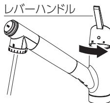
湯を使うときは、必ず水側から吐水し、ゆっくり湯側に回して温度を調節してください。
