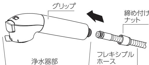
②浄水器部のグリップを持って締め付けナットにまっすぐ入れます。
