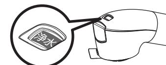
原水の場合、表示窓に「原水」と表示されます。
