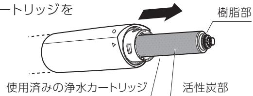
ヘッドをはずす際に、浄水カートリッジが一緒に出てきた場合は、浄水カートリッジの樹脂部を持ってまっすぐ引き抜いてください。活性炭部を持って引き抜くと樹脂部と分離して浄水カートリッジが破損し、浄水カートリッジの取り替えができなくなるおそれがありますので注意してください。
