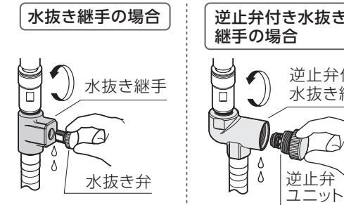
逆止弁付き水抜き継手の場合
