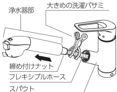
②浄水器部を回して取りはずします。
