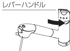
湯を使うときは、必ず水側から吐水し、ゆっくり湯側に回して温度を調節してください。
