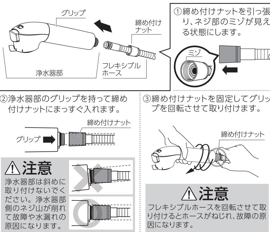
②浄水器部のグリップを持って締め付けナットにまっすぐ入れます。
