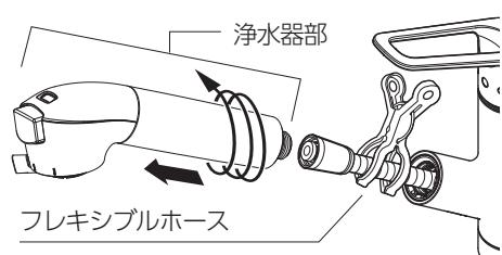
③浄水器部からヘッド、浄水カートリッジを取りはずします。
