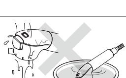
切替表示部は完全に密閉されていない為、水が浸入します。
