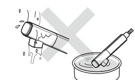
切替表示部は完全に密閉されていない為、水が浸入します。
