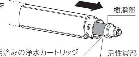
ヘッドをはずす際に、浄水カートリッジが一緒に出てきた場合は、浄水カートリッジの樹脂部を持ってまっすぐ引き抜いてください。活性炭部を持って引き抜くと樹脂部と分離して浄水カートリッジが破損し、浄水カートリッジの取り替えができないことがありますので注意してください。
