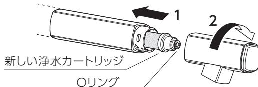
ヘッドの△印をグリップの△印に合わせてハメ込みます。
