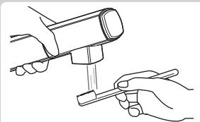
①浄水器部の吐水口を大きめのコインなどで取りはずします。
