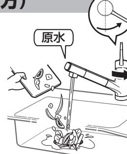
「浄水」や「温水」でディスポーザーを使用すると、流量不足により粉碎物が配管に詰まる可能性があります。
