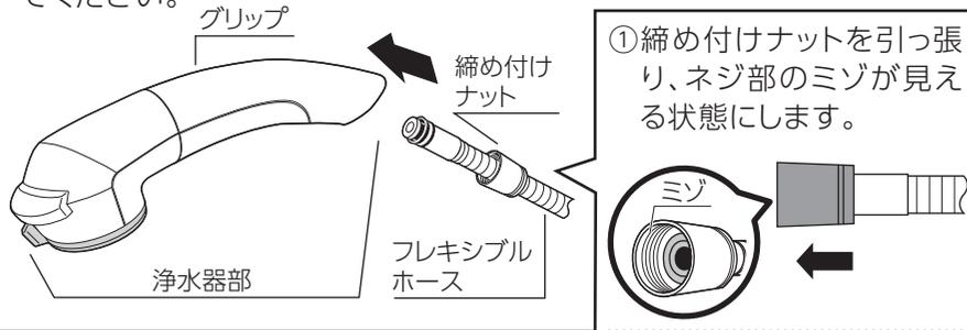
②浄水器部のグリップを持って締め付けナットにまっすぐ入れます。
