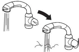
浄水器部を掃除する際は、レバーハンドルを止水側に戻し、グリップが熱くないことを確認してください。
