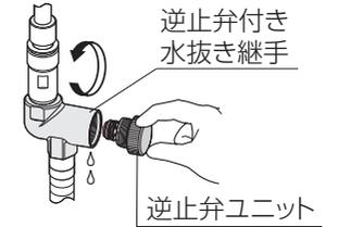
⑤水が完全に出なくなったら、図のように逆止弁ユニットを取り付けます。その後、レバーハンドルを止水状態にし、浄水器部を元に戻してください。
