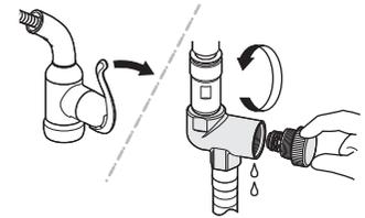
⑦水が完全に出なくなったら、図のように逆止弁ユニットを取り付けます。その後、レバーハンドルを止水状態にし、浄水器部を元に戻してください。
