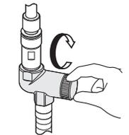
⑥レバーハンドルを吐水状態で湯側いっぱいに戻したあと、逆止弁ユニットをはずし、フレキシブルホース及び水栓の水を十分に抜いてください。
