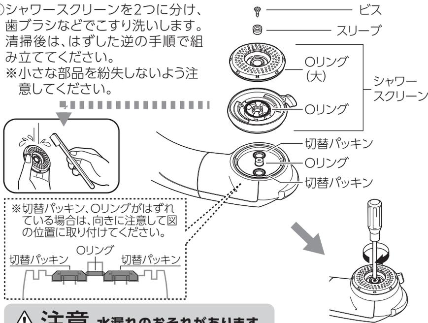
※切替パッキン、リングがはずれている場合は、向きに注意して図の位置に取り付けてください。
