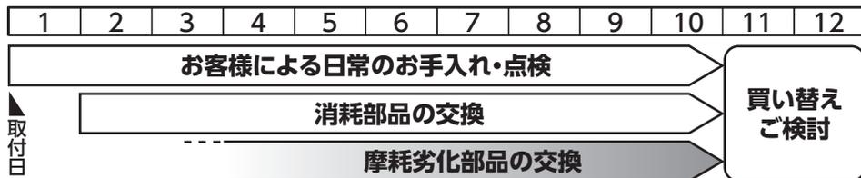
消耗部品（機能を保つ上で消費され、やがては交換されるもの）と摩耗劣化部品（摩擦などにより摩耗し、適正な動作をしなくなるもの）を総称して消耗品と表記しています。
