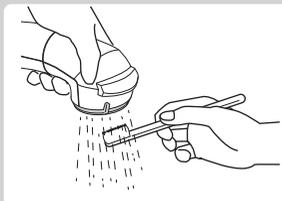
①吐水口に定規もしくはティースプーンの柄などをあて、図のように回してはずします。
