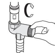
⑧再使用時に配管部の止水栓などにより通水を再開し、水漏れがないことを確認してください。
