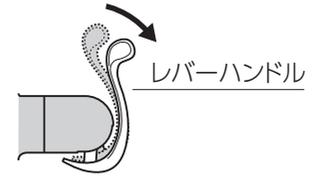
④逆止弁ユニットを図のようにはずし、フレキシブルホース及び水栓の水を十分に抜いてください。
