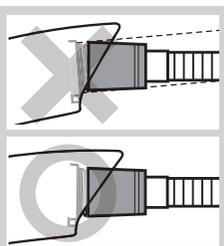
③ 締め付けナットを固定してグリップを回転させて取り付けます。
