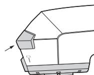
● 原水の場合、切替ボタンが突き出た状態
