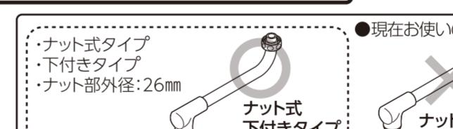
①現在使用している蛇口のスパウトナットを緩めて、スパウトを引き抜きます。
