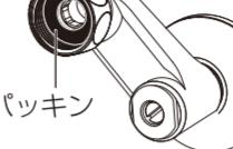
②手でナットを締め込み本体部を仮止めします。仮止めした後、本体部がまっすぐになるようにしっかりと固定し、ナットを締め込みます。
