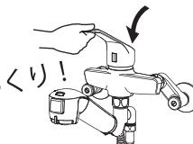
この水栓は、構造上左右に可動します。シンクより吐水部がはみ出す場合があります。ご使用の際は吐水部の位置を確認してから水を出してください。
