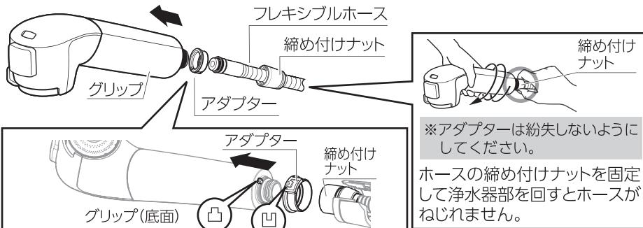
グリップの凸とアダプターの凹をあわせます。アダプターを指で固定した状態で締め付けナットへまっすぐ最後まで締めこんでください。※締め付けナットへまっすぐ締め付けないと、グリップ部のねじ部分が破損するおそれがあります。
