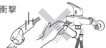
浄水器部やレバーハンドルに重い物を下げたり、力をかけて回したりしないでください。部品の破損の原因になります。
