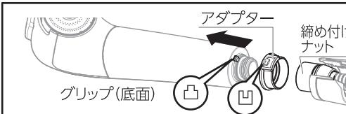
グリップの凸とアダプターの凹をあわせます。アダプターを指で固定した状態で締め付けナットへまっすぐ最後まで締めこんでください。※締め付けナットへまっすぐ締め付けないと、グリップ部のねじ部分が破損するおそれがあります。
