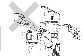
切替表示部は完全に密閉されていない為、水が浸入します。浄水器部に直接水をかけたり、水没させたりしないでください。
