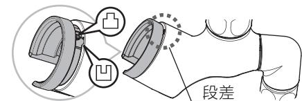
固定ブッシュを指でつまみ内側に変形させながら、固定ブッシュとスパウトの段差がなくなる所まで矢印方向へ回転させます。
