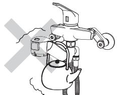
浄水器部を取りはずし、食器洗い乾燥機などで洗わないでください。
