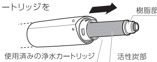
ヘッドをはずす際に、浄水カートリッジが一緒に出てきた場合は、浄水カートリッジの樹脂部を持って引き抜いてください。活性炭部を持って引き抜くと樹脂部と分離して浄水カートリッジが破損し、浄水カートリッジの取り替えができないことがありますので注意してください。
