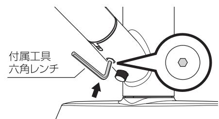
②差し込んだ付属工具の六角レンチを矢印の方向に回してネジをはずし、浄水器部を取りはずします。
