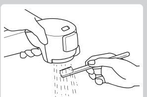
①水形切替スクリーンを「ストレート」に合わせ、スクリーン中央にある凹部に定規もしくはティースpoonの柄などをあて、図のように回してはずします。
