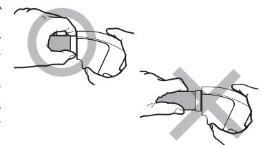
③新しい浄水カートリッジをグリップに入れ、ヘッドをグリップにハメ込み、矢印の方向へ回転させます。
