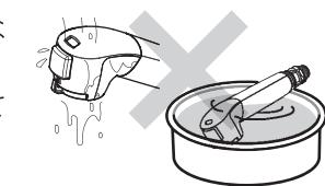
切替表示部は完全に密閉されていない為、水が浸入します。浄水器部に直接水をかけたり、水没させたりしないでください。
