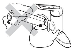
浄水器部を取りはずし、食器洗い乾燥機などで洗わないでください。
