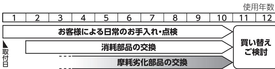
消耗部品(機能を保つ上で消費され、やがては交換されるもの)と摩耗劣化部品(摩擦などにより摩耗し、適正な動作をしなくなるもの)を総称して消耗品と表記しています。
