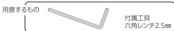
①スパウト下部のネジに付属工具の六角レンチを差し込みます。
