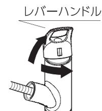
④水抜き弁を図のようにはずし、フレキシブルホース及び水栓の水を十分に抜いてください。
