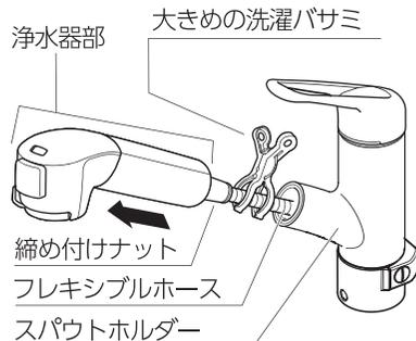
② 浄水器部を回して取りはずします。
