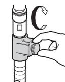
⑥レバーハンドルを上げたまま湯側いっぱいにした後、水抜き弁をはずし、フレキシブルホース及び水栓の水を十分に抜いてください。
