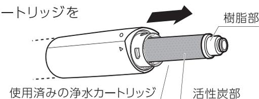
ヘッドをはずす際に、浄水カートリッジと一緒に出てきた場合は、浄水カートリッジの樹脂部を持って引き抜いてください。活性炭部を持って引き抜くと樹脂部と分離して浄水カートリッジが破損し、浄水カートリッジの取り替えができなくなるおそれがありますので注意してください。
