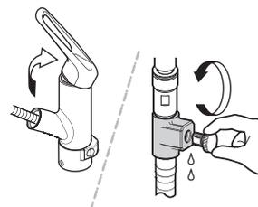
⑦水が完全に出なくなったら、図のように水抜き弁を取り付けます。
