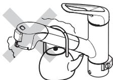
浄水器部を取りはずし、食器洗い乾燥機などで洗わないでください。
