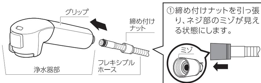
② 浄水器部のグリップを持って締め付けナットにまっすぐ入れます。
