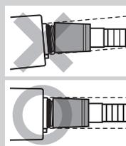
③ 締め付けナットを固定してグリップを回転させて取り付けます。
