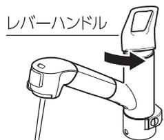
湯を使うときは、必ず水側から吐水し、ゆっくり湯側に回して温度を調節してください。
