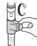
⑧再使用時に配管部の水抜き栓などにより通水を再開し、水漏れがないことを確認してください。
