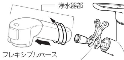
③ 浄水器部からヘッド、浄水カートリッジを取りはずします。
