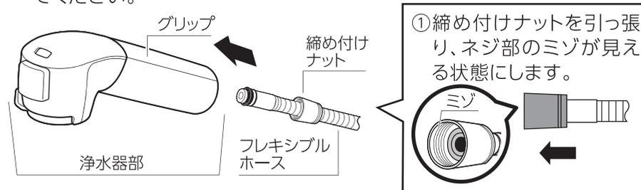
② 浄水器部のグリップを持って締め付けナットにまっすぐ入れます。
