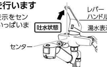
②流量調整ネジをドライバーなどで開放、または絞って適温・適量に合わせます。(水側、湯側同様)
