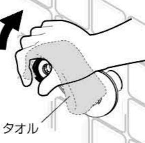
2-②で確認したクランクのねじ込み回転数を参考にして作業を進めてください。
